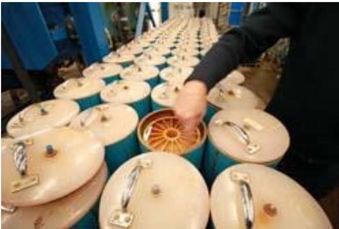
Vue sur les membranes de nanofiltration en trempage (opération de décantation).
